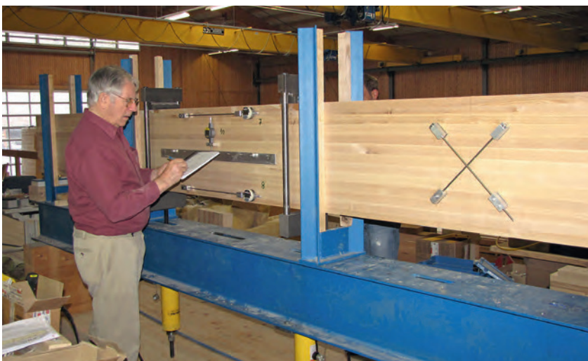
Im hauseigenen Labor werden die Produkteigenschaften ganzer Leimbinder oder einzelner Lamellen überprüft und verbessert.
